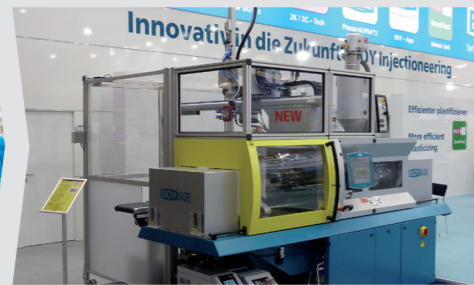
Komplette Fertigungseinheit mit CE-gerechter Schutzumhausung
